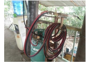
สายเครื่องตัดแก๊สได้ดำเนินการเปลี่ยนชุดใหม่จากเดิมที่มีสภาพที่ชำรุด รวมถึงการยึดโยงของถังแก๊สที่มีความมั่นคงมากขึ้น
