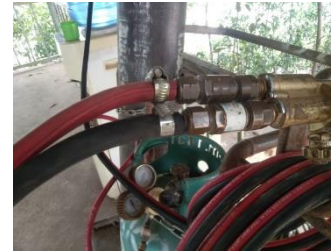
สายเครื่องตัดแก๊สได้ดำเนินการเปลี่ยนชุดใหม่จากเดิมที่มีสภาพที่ชำรุด รวมถึงการยึดโยงของถังแก๊สที่มีความมั่นคงมากขึ้น
